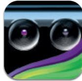
**Kinect** Sensor-Leiste zu Microsofts Spielkonsole Xbox 360. Man steuert das Spiel mittels Bewegungen und Körpereinsatz; ein Eingabegerät wird überflüssig. Diese neue Art der Spielsteuerung wird durch eingebaute 3-D-Mikrofone, Infrarot-Sensoren und Tiefen-Kameras ermöglicht.
