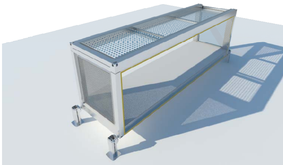
Figuur 22: Ondersteuning is aan de buitenzijde van de unit geplaatst i.p.v. eronder
