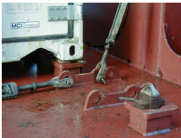
Figuur 2: Verankering d.m.v. twistlocks
