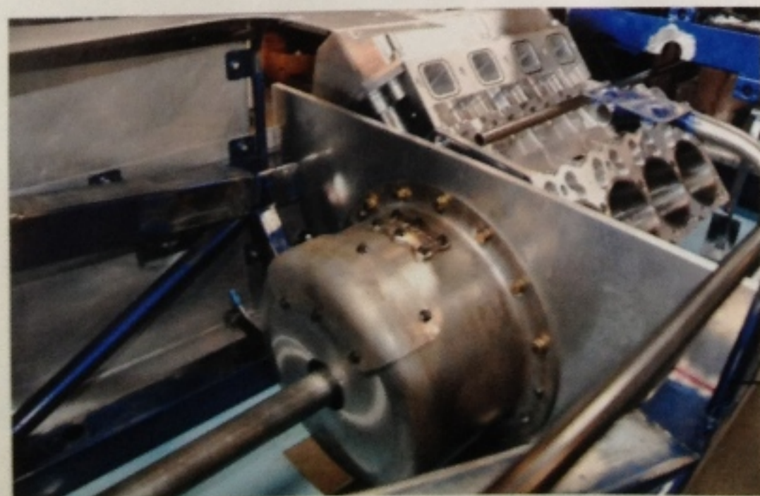
Axlarna med styrningen tillverkades speciellt för bilen på 60-talet. De liknar stora Halibrand Quick Change hus och gör det möjligt att snabbt byta utväxling om det skulle behövas.
