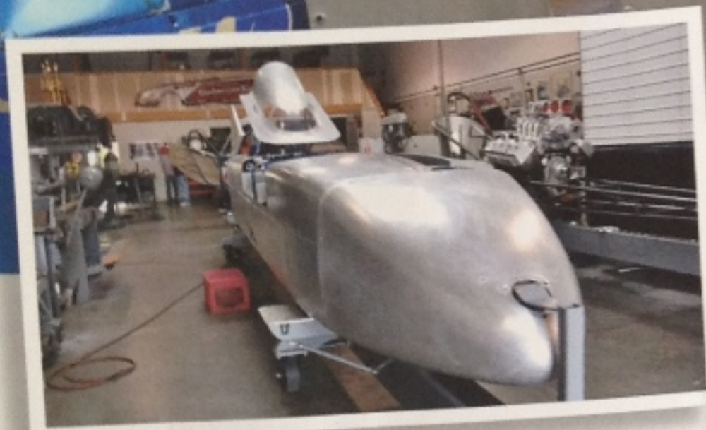
När fronten är helt klar kommer den att ha ett nytt scoop för luften till den främre motorn, utan att vara i vägen för Dannys siktfält. Danny tror att bilen kommer att väga mellan 2 500-2 600 kg, men vikt är inget problem på Bonneville.
